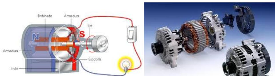
Un generador eléctrico es un dispositivo mecánico destinado a transformar el flujo magnético en electricidad mediante el fenómeno de la inducción electromagnética generando una corriente eléctrica, estos dispositivos también pueden ser utilizados en las bicicletas
