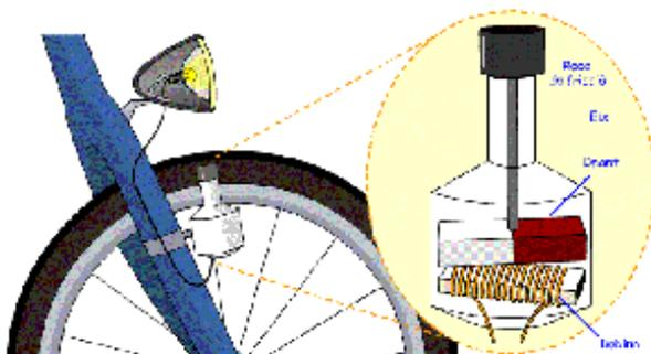
Este dispositivo funciona convirtiendo la rotación de la llanta de la bicicleta transfiriendo la rotación al eje generando la inducción electromagnética. En su interior se encuentra un imán permanente que induce un campo magnético al embobinado comúnmente llamado armadura.
